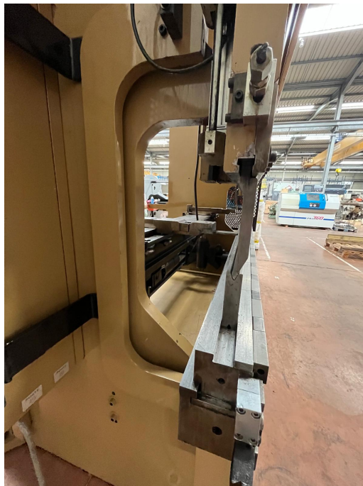
vue coté gauche serrage hydraulique des outils
