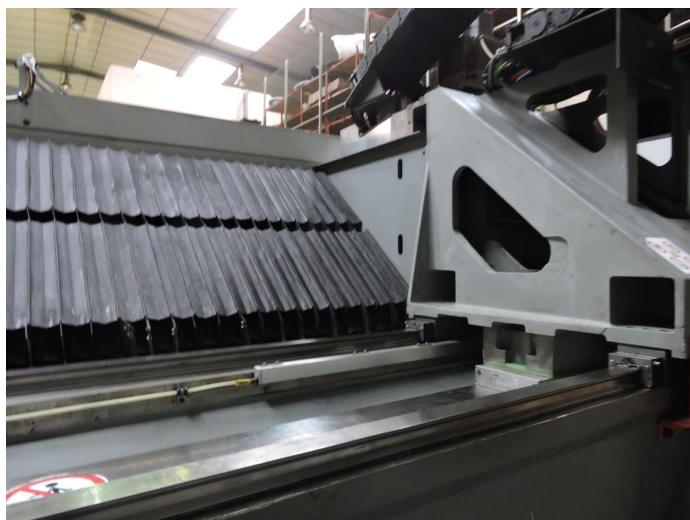
Vue glissières longitudinales
